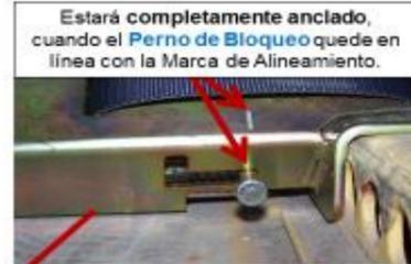
Estará completamente anclado, cuando el Perno de Bloqueo quede en línea con la Marca de Alineamiento.
