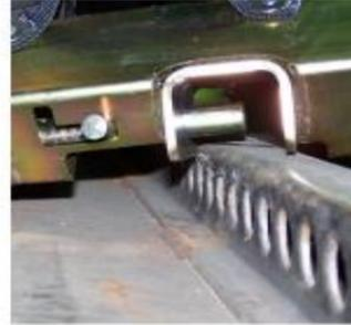
Ejemplo del Perno de Bloqueo en posición 'bloqueado'
