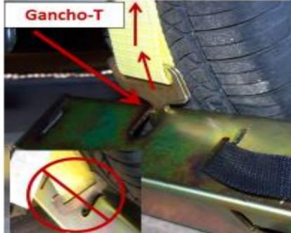
A partir del Gancho-T, tire de la eslinga hacia el chock Derecho ajustable.
