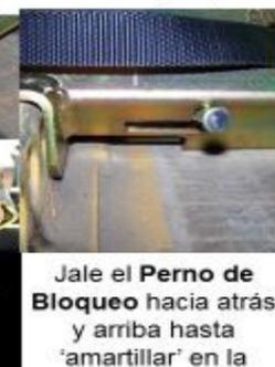
Jale el Perno de Bloqueo hacia atrás y arriba hasta 'amartillar' en la ranura vertical. Remueva el Chock.
